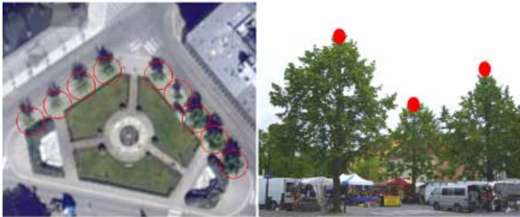
Figur C.2.6c. Mätning av träd, mitten på trädet och toppen på kronan. (Källa SOSI/FKB)
